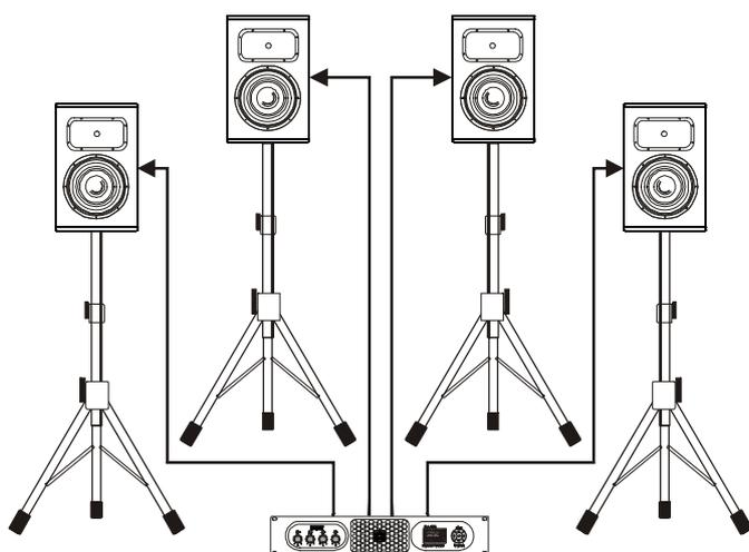
vier unabhängige, frei einstellbare Kanäle (z.B. Fullrange-Betrieb oder Topteil-Betrieb) – 4x passive Topteile (min. 700 W / 4 Ohm) oder 8x passive Topteile (min. 350 W / 8 Ohm)
