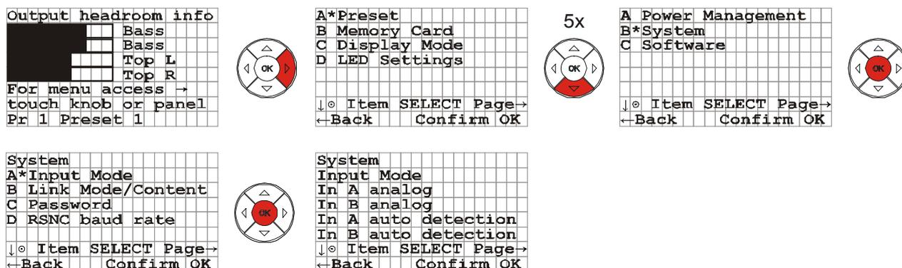
Drücken Sie nacheinander die gekennzeichneten Pfeiltasten des Navigations-Pad (wie im Schema dargestellt), um den Eingang auf „analog“ oder „digital“ oder „auto detection“ zu schalten (mithilfe der Dreh-Encoder auswählbar). Nach Ihrer Auswahl für das Eingangssignal drücken Sie die OK-Taste und verlassen das Menü über die linke Pfeiltaste.
