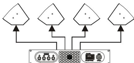
vier unabhängige, frei einstellbare Monitorwege – 4x passive Monitore (min. 700 W / 4 Ohm) oder 8x passive Monitore (min. 350 W / 8 Ohm)
