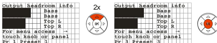
Nach dem erstmaligen Einschalten der DA 428 erscheint die linke Grafik im LCD Display. In Ihrer DA 428 ist das „Preset 1“ geladen. Um z.B. das „Preset 3 auszuwählen und zu laden drücken Sie zweimal die gekennzeichnete Pfeiltaste und bestätigen anschließend mit der OK-Taste das angewählte Preset. Wenn Sie mit einem analogen Audiosignal Ihr Audiosystem ansteuern, **können Sie jetzt starten!**
