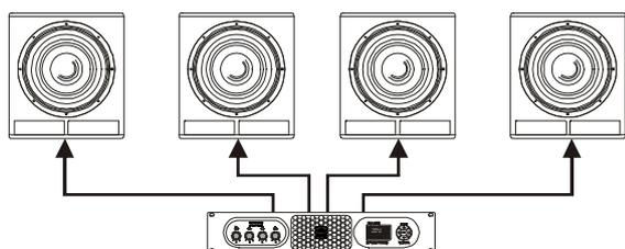
vier unabhängige, frei einstellbare Kanäle (z.B. Bass-Array) – 4x passive Subwoofer (min. 700 W / 4 Ohm) oder 8x passive Subwoofer (min. 350 W / 8 Ohm)
