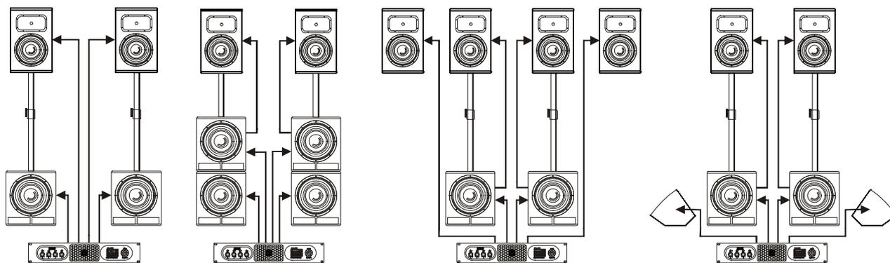
passiv und aktiv getrennte PA Systeme mit Basserweiterung (2. Bild von links) oder Topteil-erweiterung (3. Bild von links) oder Monitoreerweiterung (Bild rechts) - **Hinweis:** Hierbei ist unbedingt die Impedanz und Leistung der Lautsprechersysteme zu beachten! Nähere Informationen hierzu erfahren Sie bei Ihrem Fachhändler bzw. vom K.M.E.-Support.
